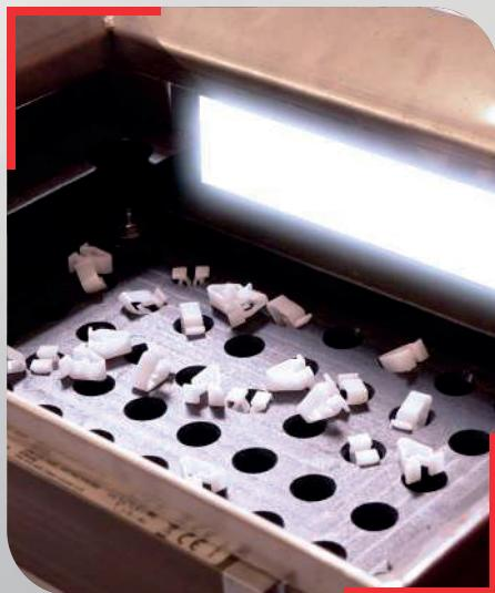
Le système permet de dévracer grâce à sa plateforme vibrante multidirectionnelle.
